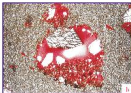
(b) 硬石膏结核溶模孔被细粉晶亮晶白云石、石英半充填, 上部有一粒自形晶方解石淀出。单偏光, \times 65 , 铸体片, 坂川1井马五 2 2 , 2-31/36, 3636.21~3636.23m
