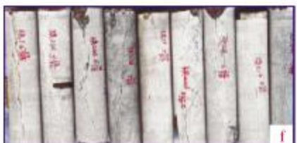
(f) 垂直岩心的样品栓中发育近纵向的裂隙, 裂隙面不平整状。岩心直径2.5cm
