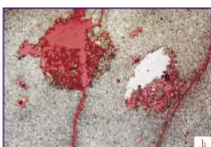
(h) 与硬石膏结核溶模孔斜切的微张裂隙使溶模孔中早期充填物发生溶解。单偏光, \times 30 , 铸体片, 统1井马五 1 1 , 6-72/141, 3055.36~3055.38m
