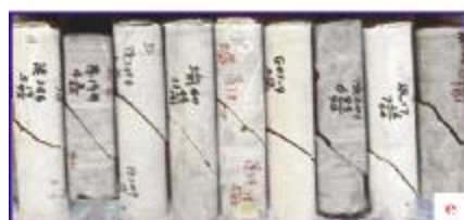
(e) 垂直岩心的样品栓中沿30°左右的剪切缝裂开(岩心中一般很难观察到), 裂开面上有的有少量暗色方解石贴裂缝面半充填, 个别裂开面上有黄铁矿淀出。岩心直径2.5cm
