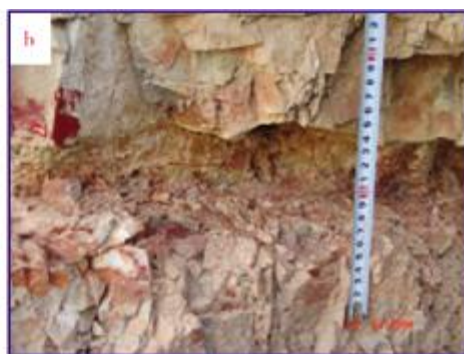
(b) 层间岩溶形成的渣状层, 顶面微起伏, 底部与白云岩过渡, 白云岩角砾化, 厚度6~9cm。三游洞群上部
