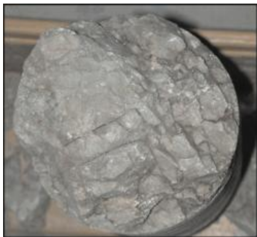
图7 奥陶系上马家沟组张裂缝 为开启的垂直裂缝。桩海102井,4457.26 m
