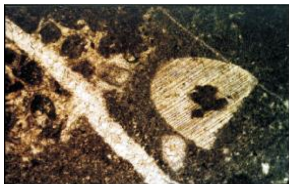
(a) 含粒屑泥晶碳酸盐岩, 粒屑为棘皮、有孔虫等生物屑及砂屑, 早期构造缝被方解石全充填。1273.10m。(-) × 40
