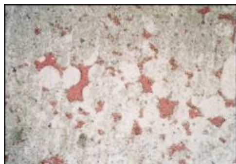
(a) 铸体薄片,红色为铸体。 \times 12.5 ,单偏光
