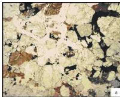
成岩裂缝。上石盒子组,CG31井,2220.0m。单偏光,10×5
