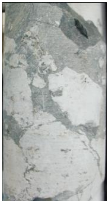
图6 7号井石灰岩洞穴被围岩角砾、钙质泥沙充填,5490.5 m
