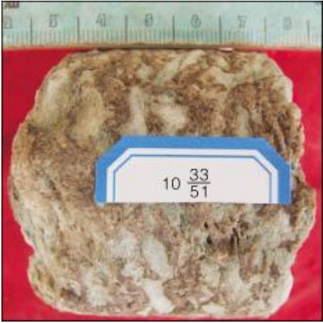
图4 3号井石灰岩洞穴被碎屑岩泥沙、砾石充填,5 829.6 m
