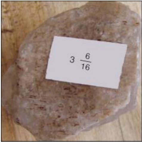
图3 4号井灰岩洞穴中的巨晶方解石胶结物,6 132.05 m
