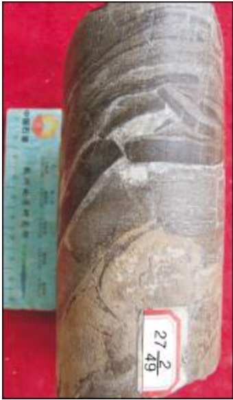
图5 6号井石灰岩洞穴被围岩角砾、钙质泥沙充填及亮晶方解石胶结,3 920.7 m
