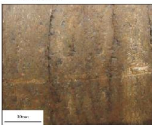
(e) 灰色鲕粒灰岩,水平层理发育,未充填。6456.78~6456.90m。岩心
