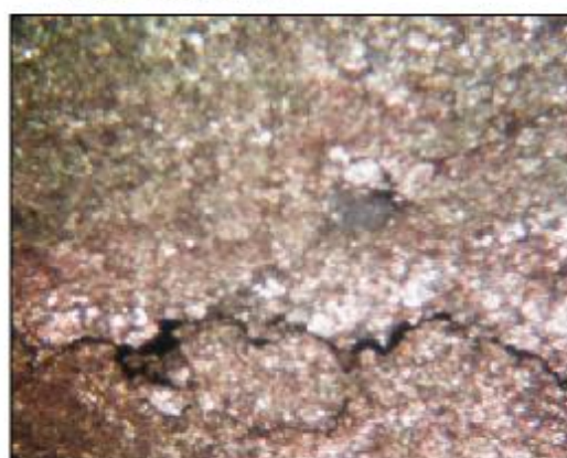
(f) 泥灰岩,见沥青充填的微裂缝。6391.75m。正交偏光,10×4
