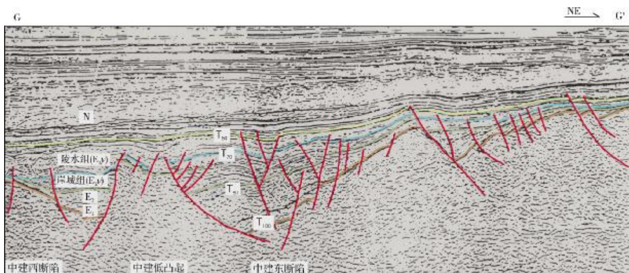
图6 中建坳陷莺北3测线地震解释剖面(据杨川恒,1997)
