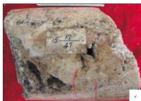
热液岩溶作用形成的洞穴为热液矿物、高温巨晶方解石及鞍状白云石充填或半充填。鹰山组, 塔中3井, 3717.23m。× 20
