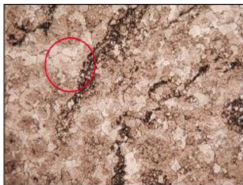
(b) 不等晶白云岩。马家沟组, 连1井, 3565.2m。对角线长4mm, (-)。图中圆内即为去白云石化形成的方解石, 颗粒中深色阴影区域显示残存部分白云石的菱形结构
