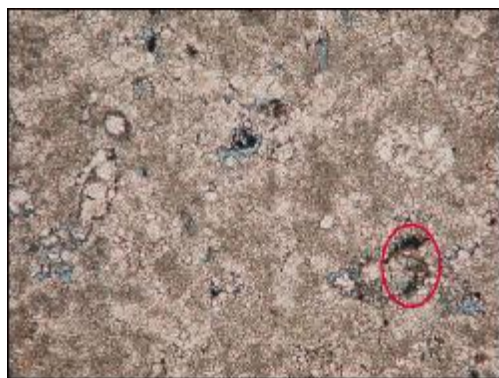
(a) 藻屑白云岩, 粒间溶孔, 如图中椭圆内所示。马家沟组六段, 尧山剖面。对角线长1.6mm, (-)
