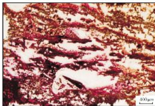
(c) 自碎角砾状安山岩。自碎缝中的示顶底构造。Ma24井, 1572.75m。铸体片, 单偏光
