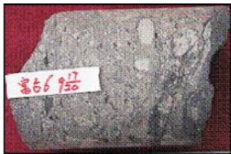
(a) 膏溶角砾白云岩。富古6井, 3198.4~3199.9m, 马家沟组五 1 层。岩心
