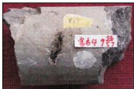
(d) 碳酸盐岩溶蚀孔洞。富古4井, 3215.8~3216.2m, 马家沟组五段。岩心
