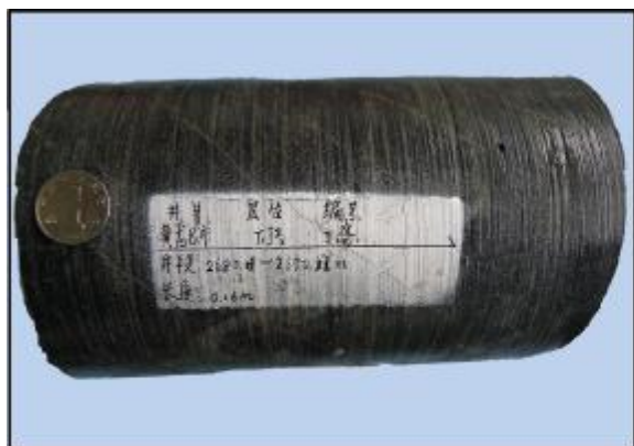
(a) 泥晶灰岩。下三叠统嘉陵江组嘉二 2 亚段, 黄龙8井, 2690.01 m。岩心
