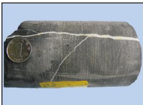
(a) 泥粉晶白云岩。下三叠统嘉陵江组嘉二 2 亚段, 温泉6井, 2036.28m。岩心
