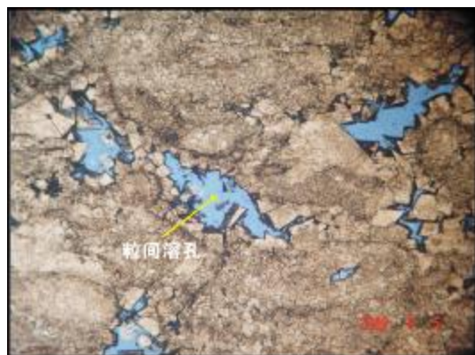
(a) LG I 型(台地边缘) 残余生物碎屑白云岩, 粒间溶孔。孔隙度 3.92%, 渗透率 1.13 \times 10^{-1} \mu\text{m}^2 。LG2 井, 6126.13m。单偏光
