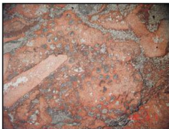
(b) LG II型(台地内部), 串管—硬海绵障礁白云质灰岩。LG11井, 6058.28 ~ 6058.54 μm。单偏光
