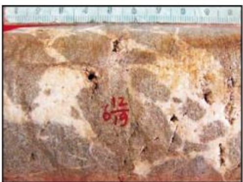
(e) 灰色细晶白云岩。发育高角度裂缝,破碎岩石呈角砾状,角砾间充填白色鞍状白云石,残留部分溶孔;岩心表面见油气侵染现象。上寒武统, TZ7井4097.80m。岩心
