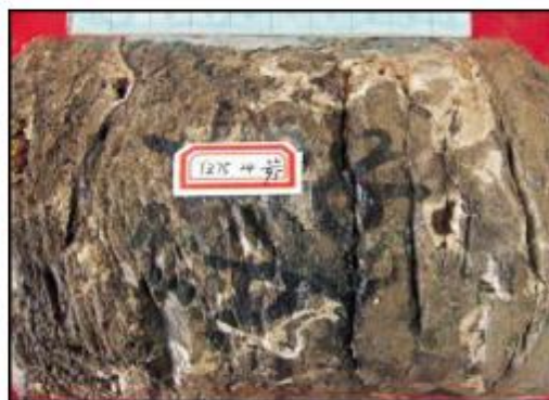
(d) 褐灰色中晶白云岩。网状裂缝极其发育,切割岩石呈角砾状,沿裂缝局部发育大溶孔。裂缝及孔隙边缘充填鞍状白云石及石膏,残留部分孔隙。上寒武统, TZ75井4810.3m。岩心
