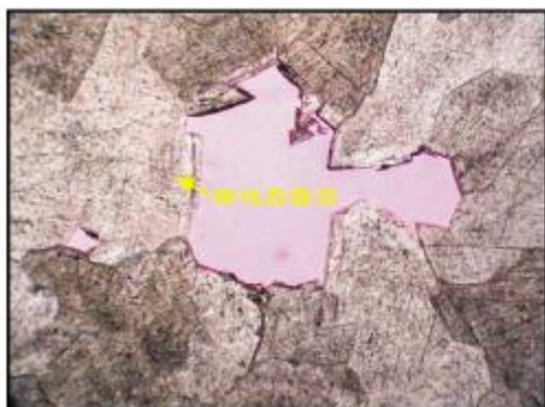
(a) 白云岩裂缝中充填粗晶鞍状白云石,残留溶孔。中下奥陶统鹰山组, H4井4477.55 m。红色铸体, (-) × 40
