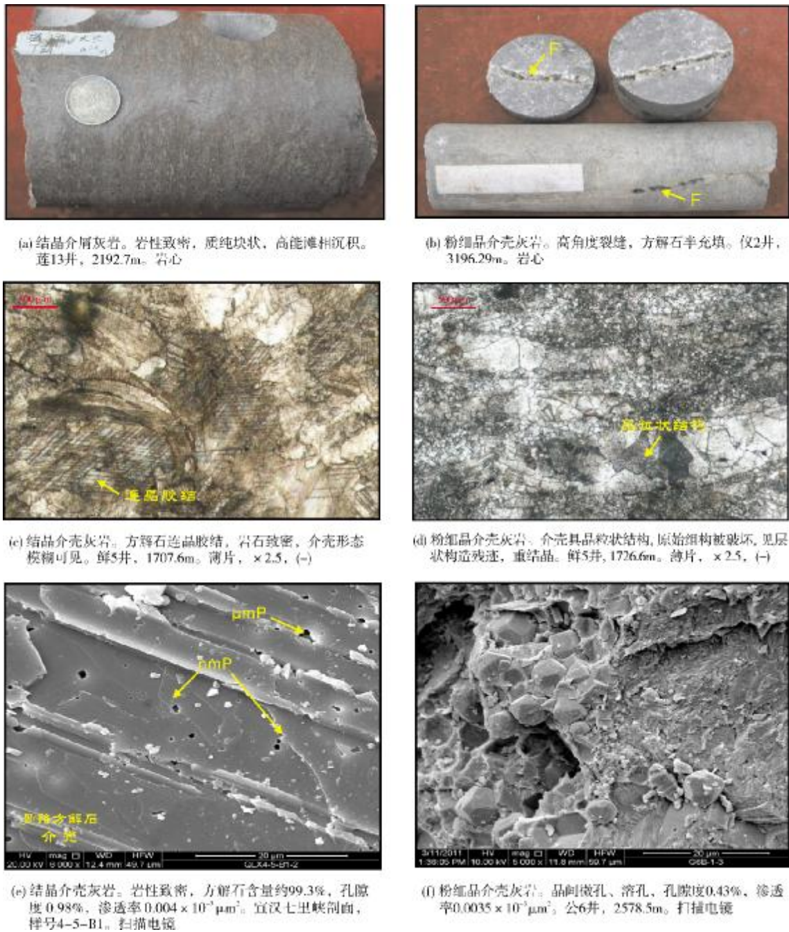
图3 四川盆地中部大安寨段结晶介壳灰岩储层特征 F 裂缝；P 孔隙； \mu\text{mP} 微米级孔隙； \text{nmP} 纳米级孔隙
