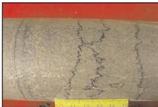
(b) 亮晶鲕粒灰岩, 其中压溶缝合线发育。X井6504.21m, 飞仙关组二段。岩心
