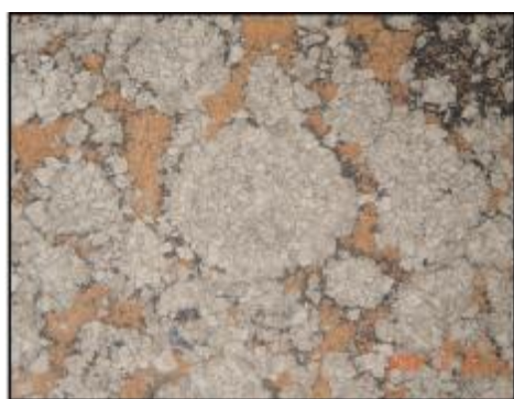
(a) 含灰鲕粒白云岩, 鲕粒及第一期胶结物被白云石化, 第二期胶结物(被染成红色)未白云石化。X井5989.7m, 飞仙关组三段。薄片, \times 25 , (-)
