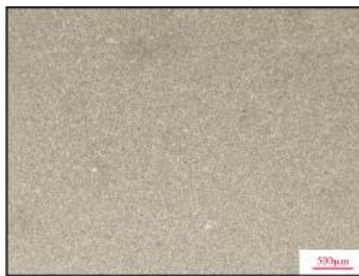
(b) 泥晶白云岩。岩性致密, 基本不发育孔隙。苏2井, 3592.08m, 马五亚段。铸体片, 单偏光
