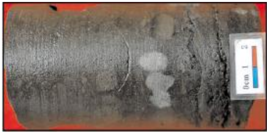
(a) 灰色泥粉晶白云岩。见裂缝, 针孔状溶孔发育。龙岗172井 3711.25 ~ 3711.39m, 雷口坡组四段。岩心
