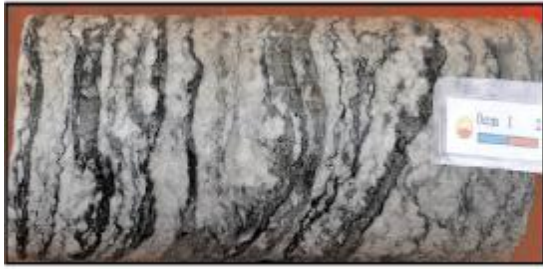
(c) 灰白色膏岩。夹灰色和深灰色藻层白云质泥质条带。苏码1井4167.36 ~ 4167.55m, 雷口坡组四段。岩心
