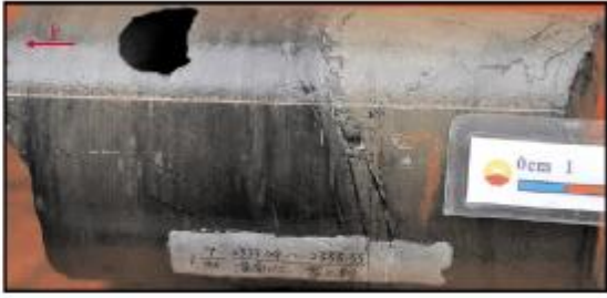
(d) 深灰色泥晶灰岩(上部)和灰褐色泥粉晶灰岩(下部), 中间见裂缝及缝合线。潼南112井2333.04 ~ 2333.35m, 雷口坡组二段。岩心
