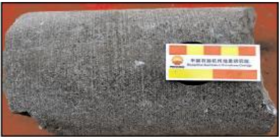
(b) 灰褐色砂屑白云岩。含斑状石膏。广100井3039.85 ~ 3040.10m, 雷口坡组一段。岩心
