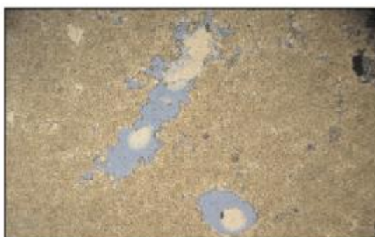
(d) 岩溶角砾岩。具有模孔。A23井3666.63m, 薄片(-), \times 100
