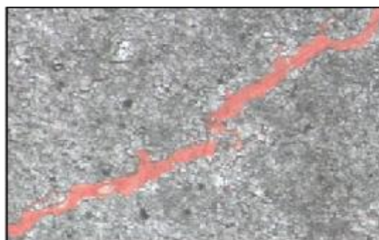
(f) 泥晶白云岩。见溶缝, 被方解石全充填。A001-11井4102.10m, 薄片(-), \times 100
