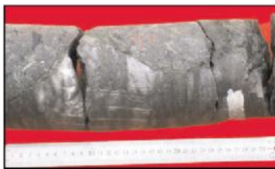
(b) 岩溶角砾岩。见溶沟, 被泥质半充填、全充填。A19井3754.92~3755.32m, 岩心
