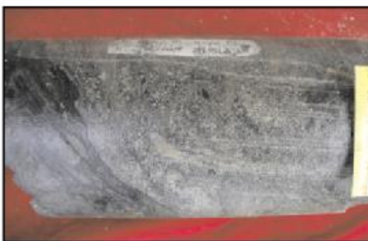
(h) 岩溶角砾岩, 多种机械碎屑物与渗流通道充填溶沟。A166井4062.70~4062.95m, 岩心
