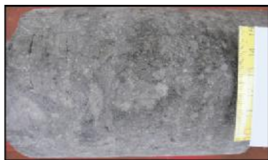
(a) 岩溶角砾岩。见溶沟, 充填机械碎屑物。A166井4053.3~4053.43m, 岩心
