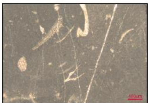
(c) 含生物碎屑泥晶灰岩。岩石致密, 孔隙不发育。鄂尔多斯盆地环县甜水堡, 克里摩里组。薄片(-), \times 50
