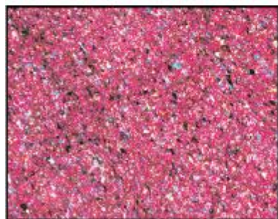
(d) 沉火山尘凝灰岩。主要矿物成分为长石和石英, 含碳屑, 未见黏土矿物, 无显孔。火北 1 井 2395.70m, 中二叠统平地泉组。与图(c)对应的薄片, 正交光+石膏试板, \times 100
