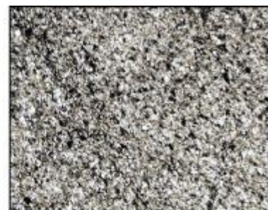
(c) 沉火山尘凝灰岩。主要矿物成分为长石和石英, 含碳屑, 未见黏土矿物, 无显孔。火北 1 井 2395.70m, 中二叠统平地泉组(与芦草沟组对应)。薄片, 单偏光, \times 100
