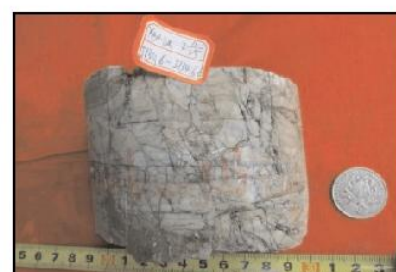
(l) 浅黄灰色粉细晶白云岩。见网状裂缝, 断面见硅质结核。见高角度缝被低角度缝切割现象。YB1-2x井5134.6~5134.66m, 鹰山组, 局限台地相。岩心
