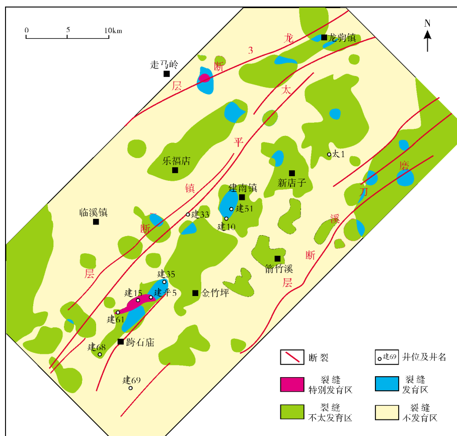
图4 建南地区飞仙关组三段储层构造裂缝的综合预测结果图
