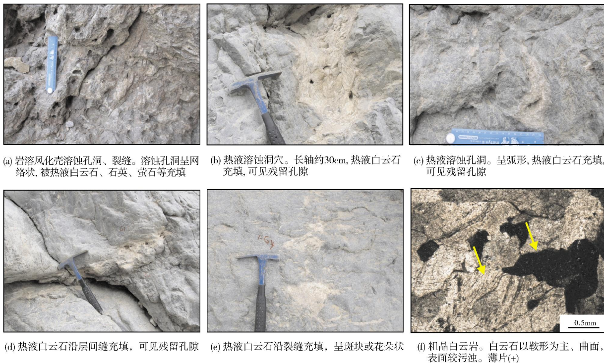
图9 塔里木盆地西北缘肖尔布拉克西沟剖面上震旦统奇格布拉克组热液改造型白云岩储层宏观与微观特征
