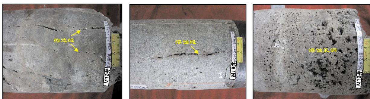
(a) 砂屑白云岩。滩核部位。浅灰色,厚层;高角度构造缝发育,充填程度低。M13井4618.59m。岩心
