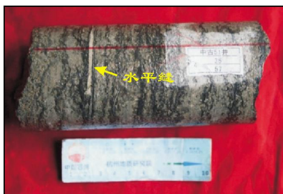
(d) 层间缝,被方解石完全充填。G51井5042m,良三段。岩心
