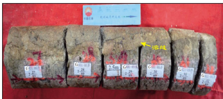
(a) 高角度溶缝,方解石完全充填。G431-H5井5146m,良二段。岩心
