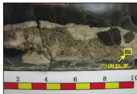
(b) 高角度宽缝中方解石、重晶石和萤石等部分充填,裂缝中发育围岩碎屑。T12井4706m,良二段。岩心
