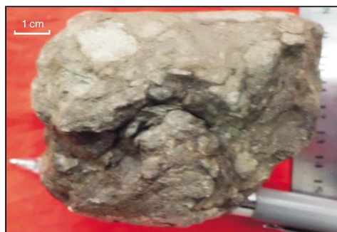
(a) 黄灰色泥晶砂屑灰岩,发育岩溶角砾。玉北7井 5 807.6 m, 鹰山组上段。岩心
