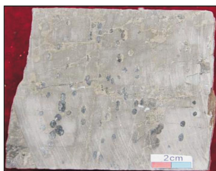
(b) 褐灰色细粉晶白云岩,方解石、白云石粉砂充填膏模孔。榆82井2 836.2 m, 马五 1 2 小层。岩心
