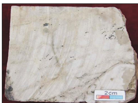
(a) 浅灰色细粉晶白云岩,岩溶角砾化。双5井 2 635.1 m, 马五 1 2 小层。岩心
