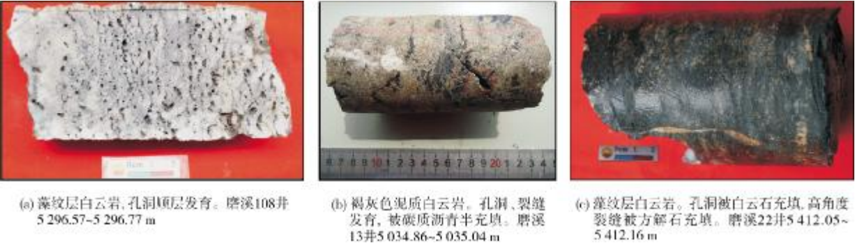
图3 川中磨溪地区灯四段上亚段岩心典型岩溶特征
