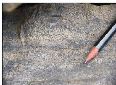
(d) 亮晶鲕粒白云岩。沙滩野外剖面
