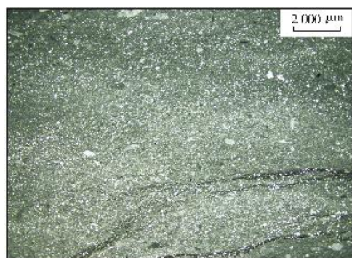
(a) 砂质泥晶白云岩。鼓城野外剖面。单偏光
