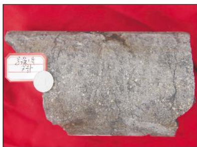
(h) 灰色泥晶白云岩, 见石膏假结核。MS1井7 302.63~7 302.81 m。岩心
