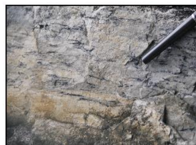
(j) 灰色厚层状白云质灰岩。见针孔状孔隙, 沥青充填。呈子山野外剖面
