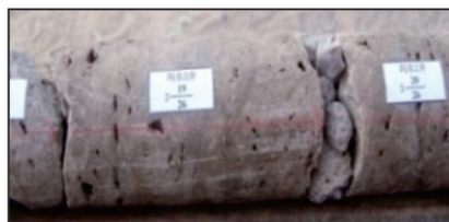
(e) 细中晶白云岩,孔洞层状分布。MD2井 4 650.1 m,距潜山面385 m。覆盖区
