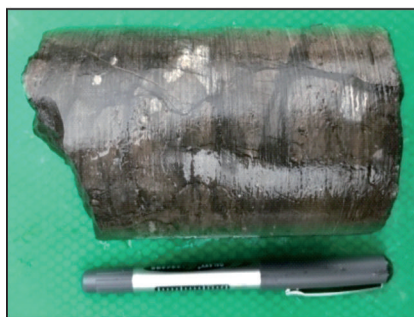
(g) 风化网状裂缝。XS1井6 131.50 m, 雷三段
