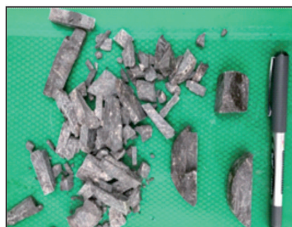
(f) 破碎状裂缝, 可能是裂缝网格化切割岩石形成的破碎带。PZ1井5 820.30 m, 雷四段
