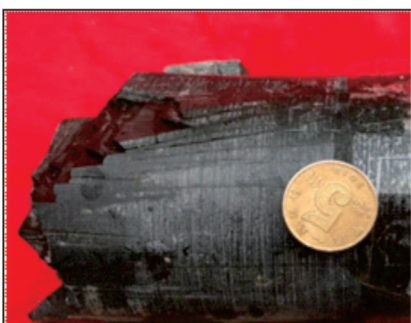
(e) 破碎状裂缝, 呈片状。X1井5 729.53 m, 雷四段
