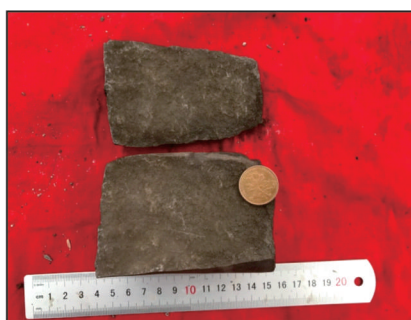
(b) 张性裂缝, 缝面粗糙。Y1井5 775.33 m, 雷四段
