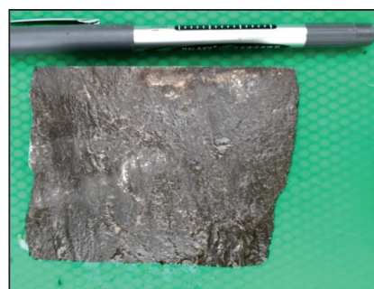
(c) 剪性裂缝。PZ1井5 810.05 m, 雷四段
