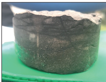
(h) 风化网状裂缝。PZ1井5 719.75 m, 雷四段
