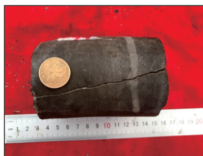
(a) 张性裂缝。Y1井5 775.33 m, 雷四段
