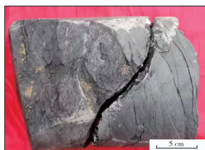
(a) 灰质页岩相,以深灰色泥晶灰岩为主,夹薄层碳质泥岩,裂缝中可见方解石脉。1 648.1 m, 岩心
