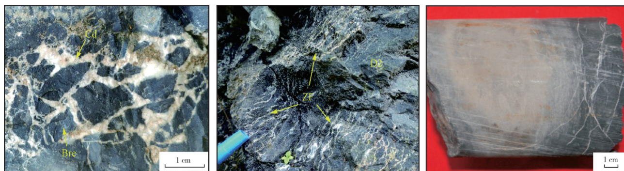
(a) 热液角砾岩。Bre为茅三段热液角砾岩; Cd为白云石胶结物。四川盆地, 丰都放牛坝剖面 (b) 斑马状构造。ZF为斑马状构造; D2为茅二段细-中晶白云岩。四川盆地, 洪雅张村剖面 (c) 泥岩褪色呈土黄色。歧口凹陷, GG16102井2 182.30 m, 上古生界太原组。岩心
