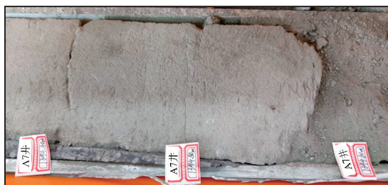
(c) 在分选中等的细砂岩(疏松)之上的差分选细砂岩中,形成钙质砂岩夹层。A7井1 394.4~1 394.6 m, 韩江组
