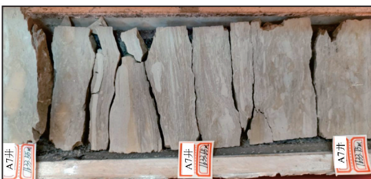
(d) 在浅灰色钙质泥岩中,常夹褐色泥岩条带,具潮汐层理。A7井1 633.55~1 633.75 m, 珠江组
