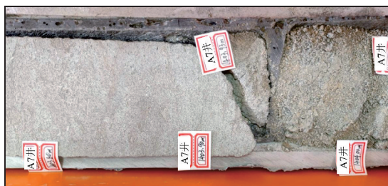
(a) 在分选较好的中粗砂岩(疏松)之上的细砂岩中,形成钙质砂岩夹层。A7井1 403.80~1 404.0 m, 韩江组
