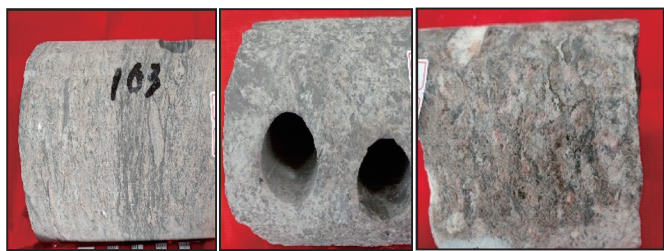
(a) 水平潜流带,磨圆砾岩。R2井 3 041.83 m (b) 暗红色角砾白云岩。R2井 3 023.1 m (c) 杂乱白云岩角砾堆积,大部分发生去白云石化作用。R2井 3 034.5 m
