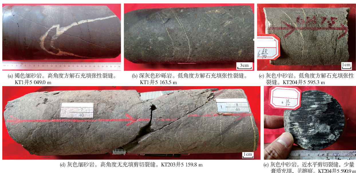
图3 KT1气藏亚格列木组典型岩心裂缝
